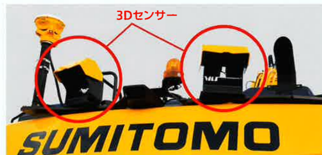
■4つの3Dセンサーで反射物だけを検知
